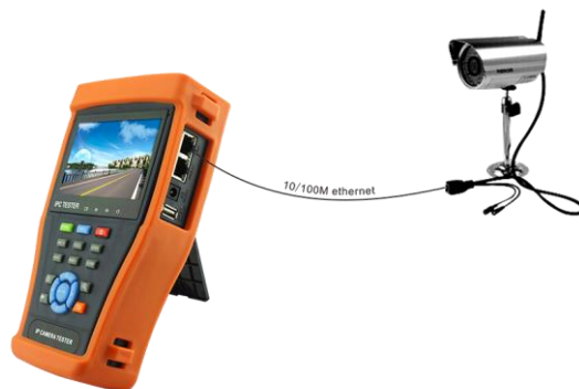
Рис 3.2.1-1. Подключение тестера к IP-камере.
