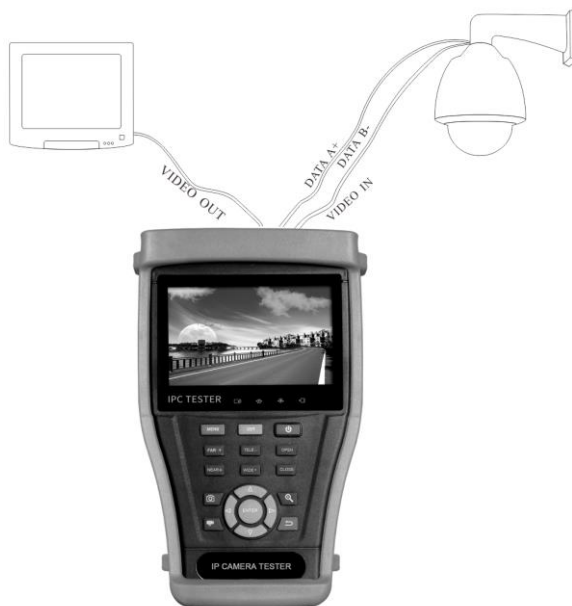
Рис 3.2.2-1 Подключение тестера к аналоговой камере.
